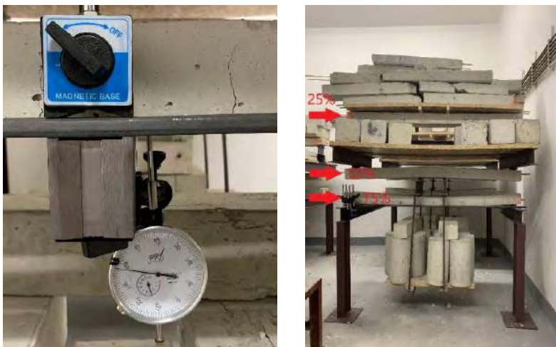
Obrázok 4: Zaťažovacia zostava- dlhodobé merania
