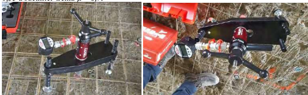
Obr.7 Ťahové skúšky spriahajúcich konektorov
