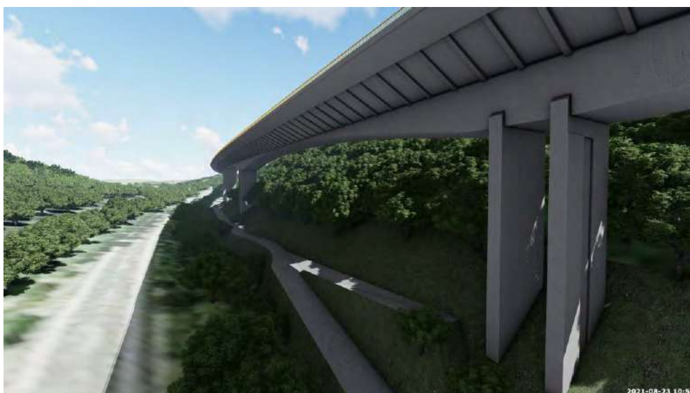
Obr. 3 – 209-01 Vizualizácie dilatačného celku stavaného letnou betonážou
