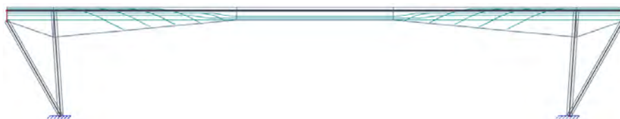
Obr. 10 – Výpočtový model mosta v programe SCIA Engineer.
