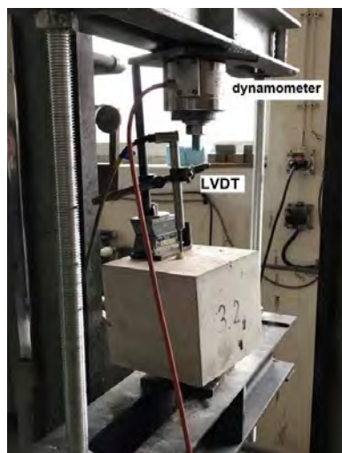
Obr. 2.2 Vyťahovacia skúška súdržnosti
