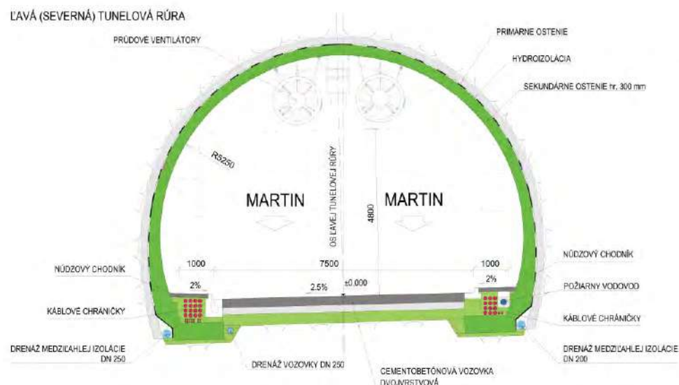
Obr. 2 Vzorový pričný rez – základové pásy
