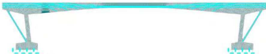
Obr. 9 – Výpočtový model mosta v programe ATENA 2D.
