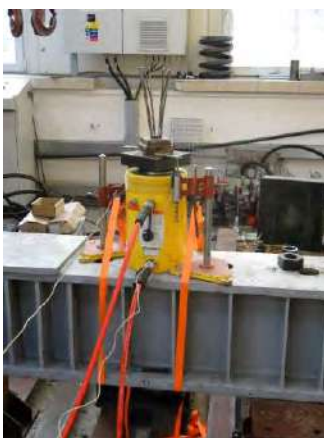
Obr. 6 a) Testovacia zostava, b) záznam skúšky 3 kotvy 10 \phi P 4,5 mm
