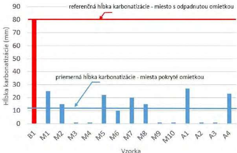
Obrázok 3 Hĺbka karbonatizácie betónu pod ochrannou krycou omietkou a na odpadnutom mieste - most Sládkovičovo
