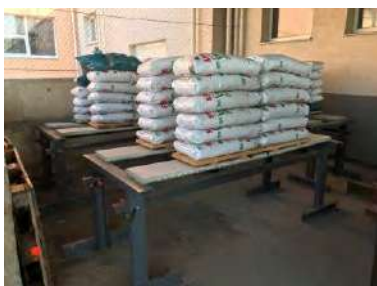
Obr. 6.1 Zaťažovacia zostava pre sledovanie dlhodobých vlastností GFRP výstuže
