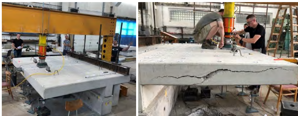
Obr.5.2 Test mostkovej dosky so šmykovou štihlosťou 5 počas skúšky a po porušení
