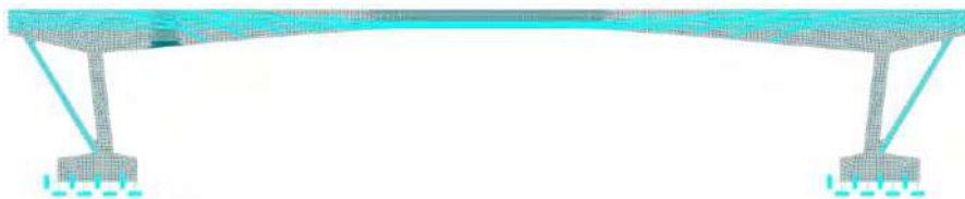
Obr. 9 – Výpočtový model mosta v programe ATENA 2D.
