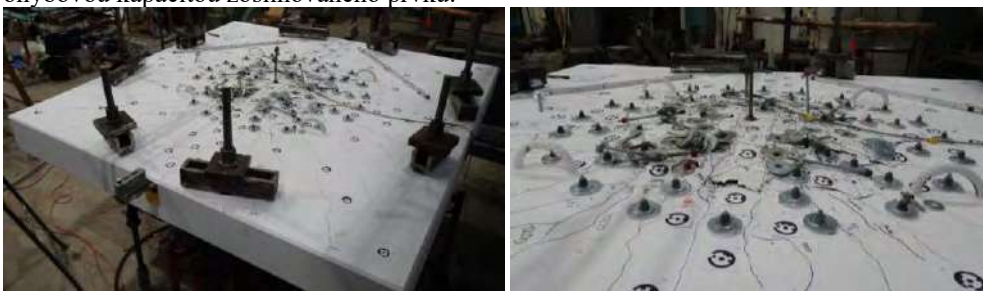
Obr. 4.2 Doska FS-03 po porušení
