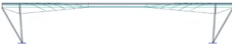
Obr. 10 – Výpočtový model mosta v programe SCIA Engineer.
