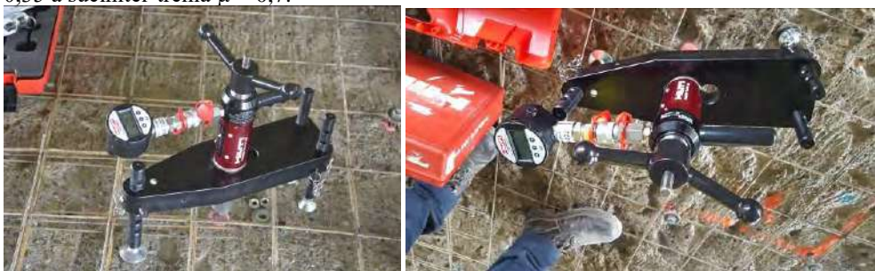
Obr.7 Ťahové skúšky spriahajúcich konektorov
