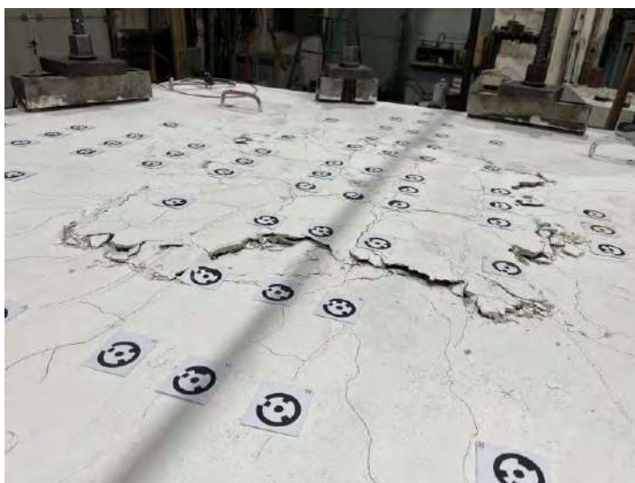
Obr. 4.3 Zlyhanie jednej z dosiek s GFRP výstužou
