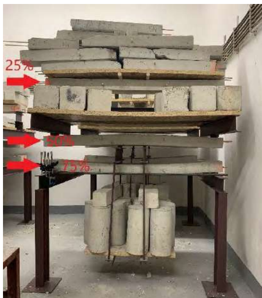
Obr. 5.1 Fotografia dlhodobej zaťažovacej zostavy (percento zaťaženia nosníkov vyznačené červenou farbou)
