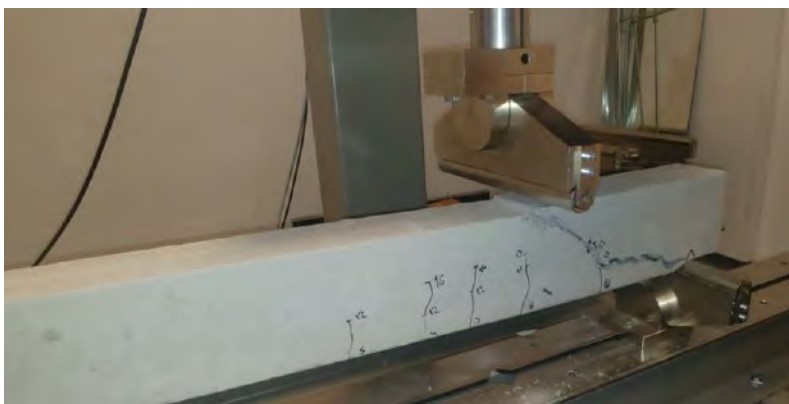
Obr. 3.1 Porušenie nosníka v šmyku
