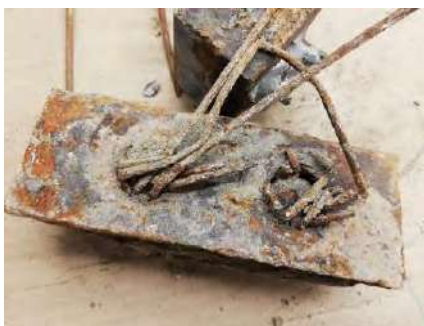
Obr. 4 a) Most Podbiel – kotevná oblasť, b) Most Nižná – detail odkorodovaných káblov, nefunkčná dvojkotva
