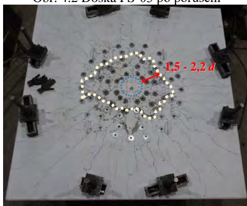
Obr. 4.3 Tvar kontrolného obvodu po porušení
